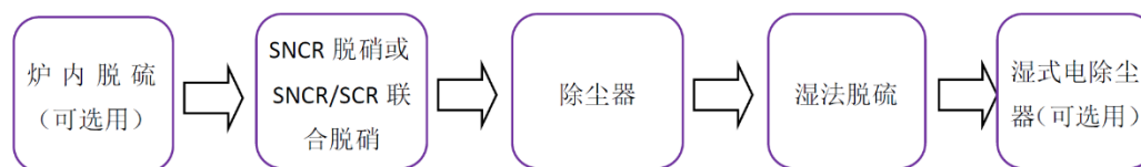
图5.2-1 超低排放工艺流程2（循环流化床锅炉）
