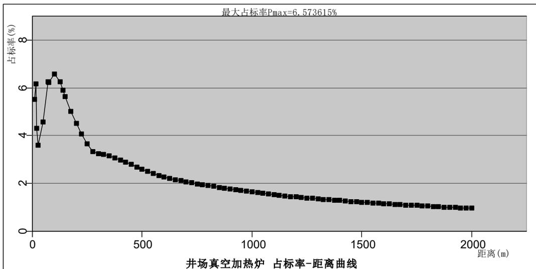
图 2.4-1 真空加热炉烟气 NO<sub>2</sub> 占标率-距离曲线图
