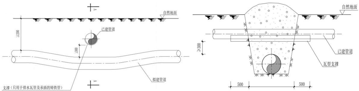
图 3.3-6 管道交叉施工作业示意图
