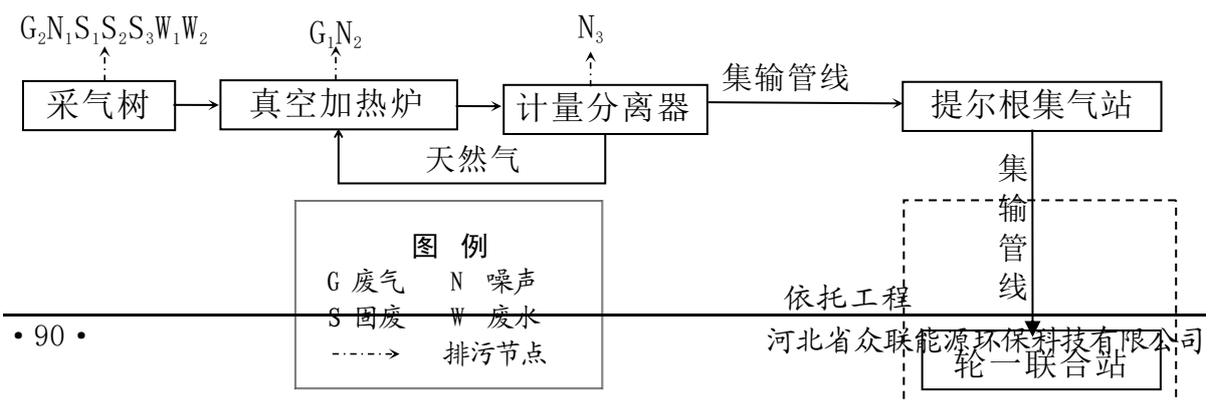
图 3.3-7 井场油气开采及集输工艺流程图
