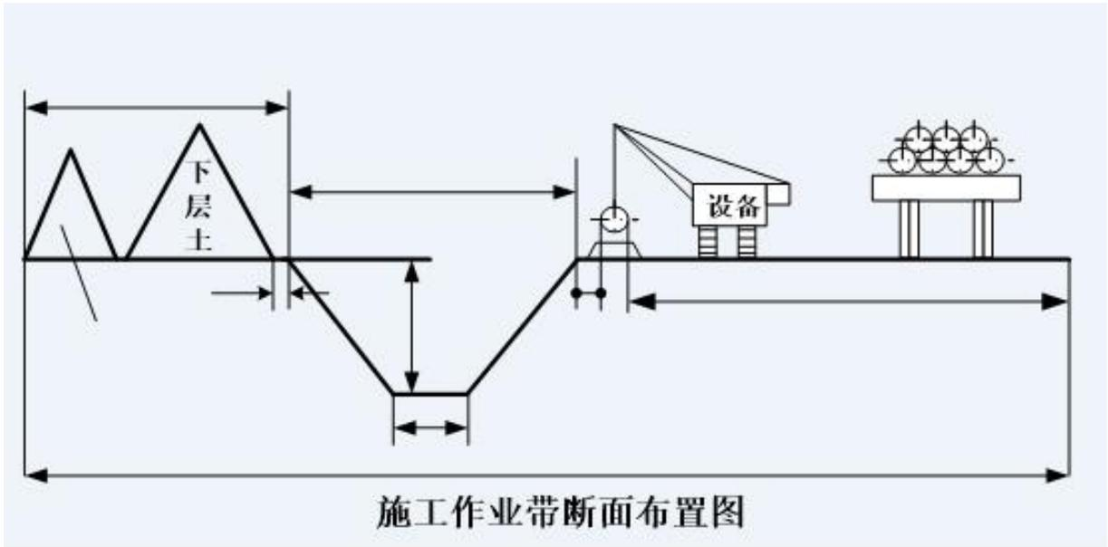
图 3.3-5 一般地段管道施工方式断面示意图
