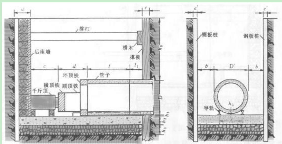
图 3.2-4 顶管施工工作坑构造和设施示意图
