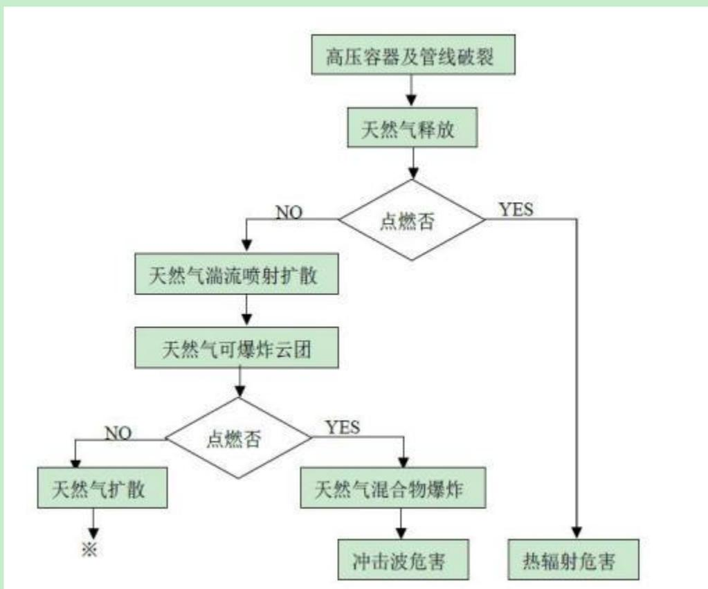
图 5.6-1 输气管道事故树分析示意图
