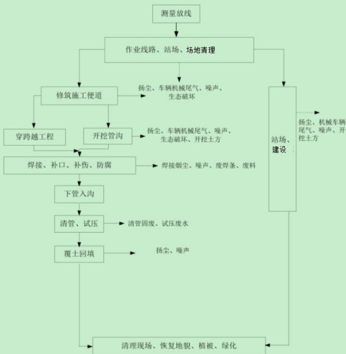
图 3.2-1 施工工艺及产污环节图
