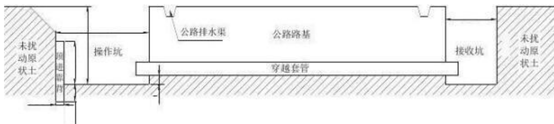
图 3.3-3 穿越道路施工作业示意图
