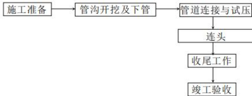
图 3.3-1 管道工程施工阶段工艺流程图
