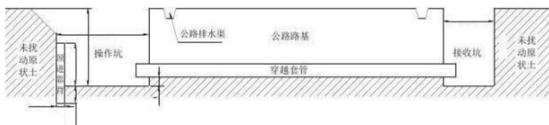
图3.3-3 穿越沥青道路施工作业示意图
