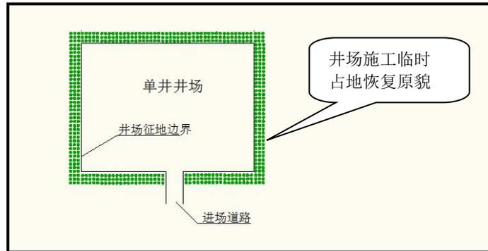
图 6.5-1 井场的典型生态保护措施设计图
