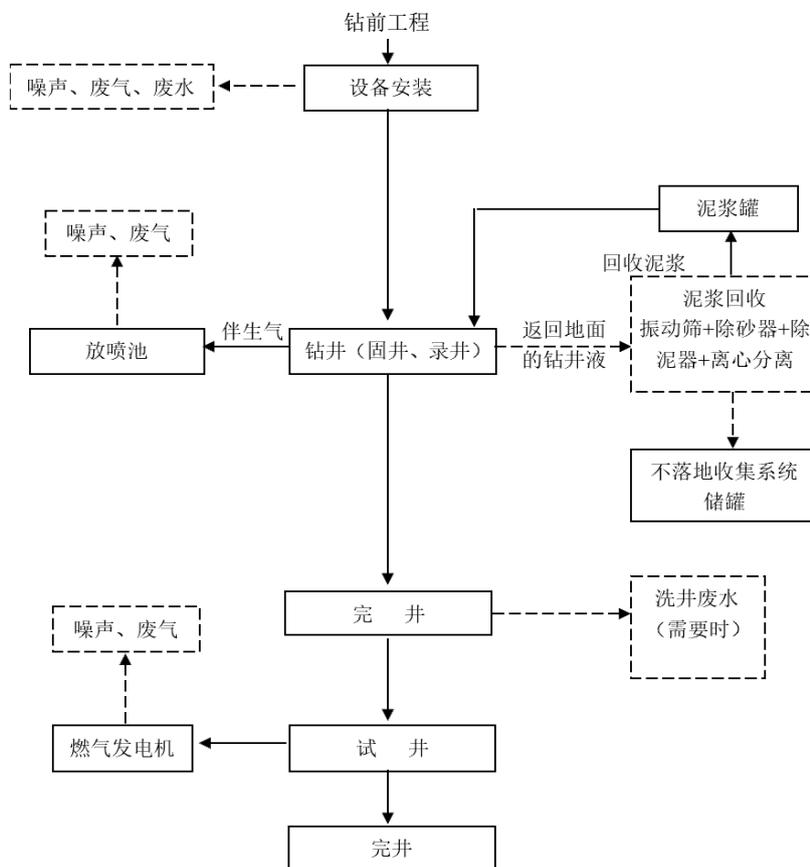
图 3.3-6 钻井工程及产污环节示意图
