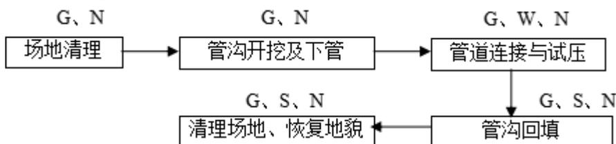
图 3.3-8 油气集输工程工艺流程及排污节点图
