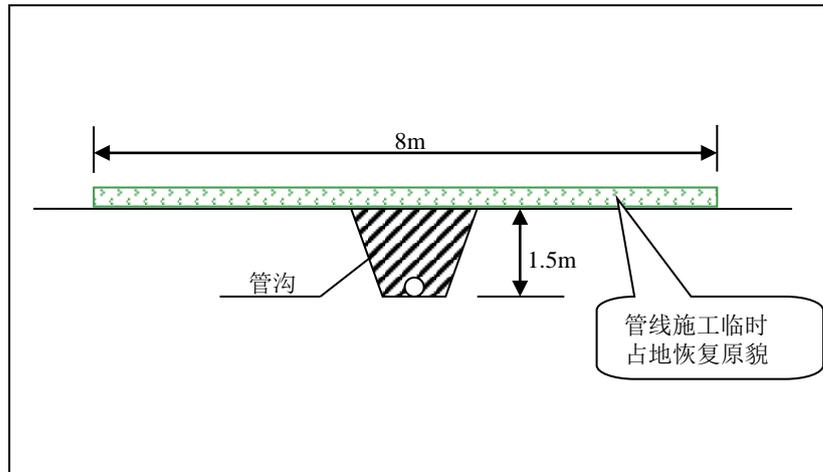
图 6.5-2 管线的典型生态保护措施设计图
