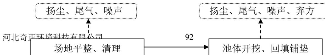
图 3.3-5 钻前工程施工过程及产污环节示意图
