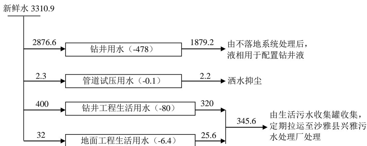
**图 3.3-4 项目施工期给排水平衡图 (单位：m<sup>3</sup>)**
