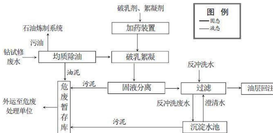
图 3.2-5 废水处理工艺流程图
