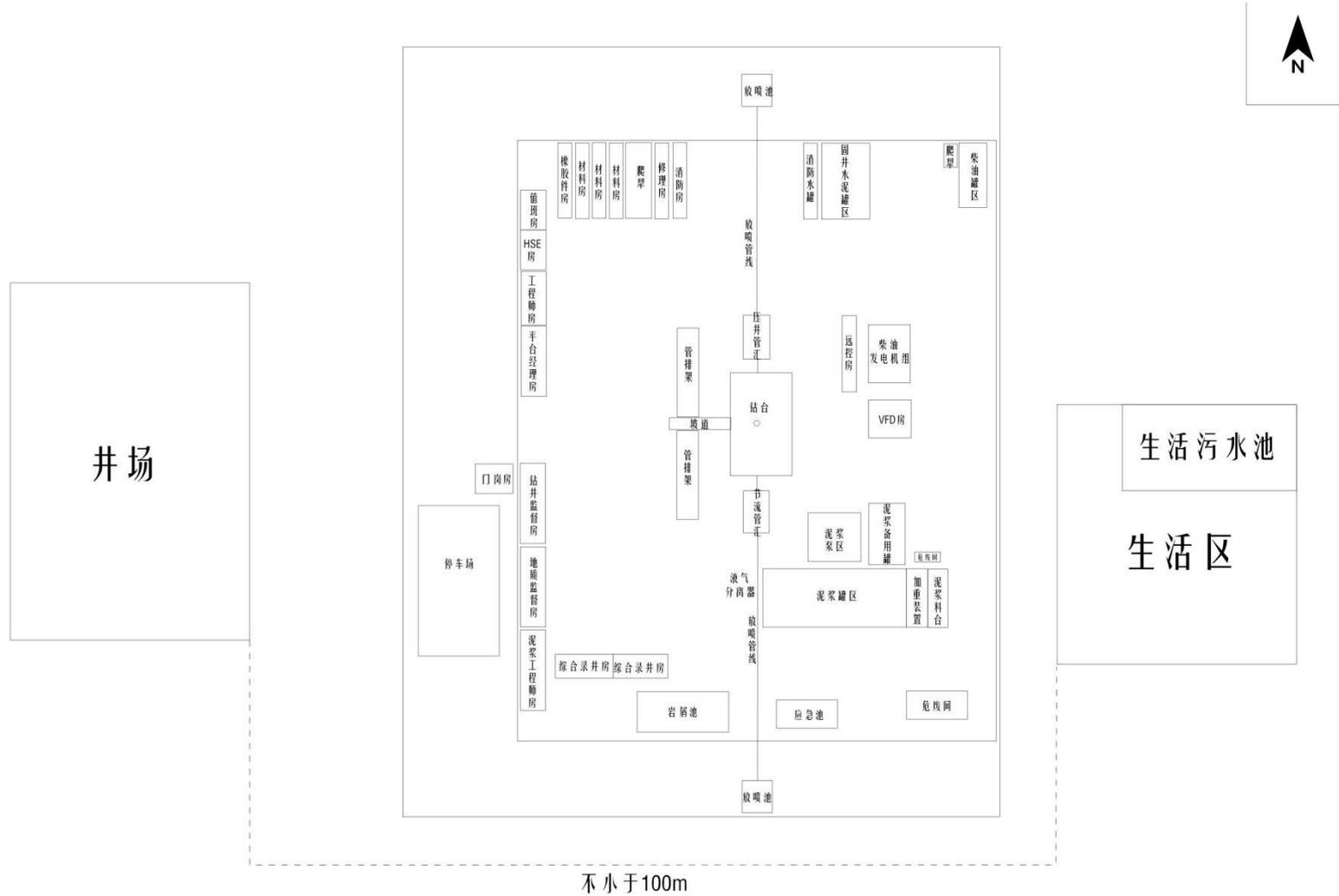
图 3.3-2 钻井期井场平面布置示意图
