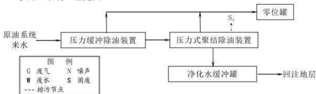
图 3.2-3 水处理系统工艺流程图
